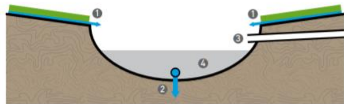
Noue de rétention
