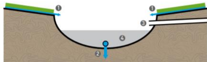
Noue de rétention
